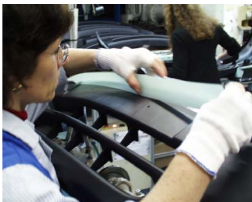
Atelier injection. Gestes précis de marouflage.
