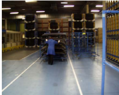
Atelier injection, postes de marouflage, en sortie de presse, manutention des chariots à roulettes vers la zone de prise en charge par les caristes.
