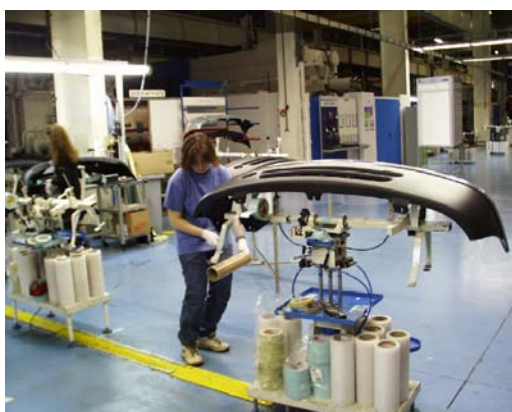
Atelier injection. Découpe de papier collant au poste de marouflage.
