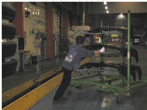
Atelier peinture, manutention des chariots venant de l'atelier injection pour installer les pare-chocs sur les mâts des cabines de peinture.
