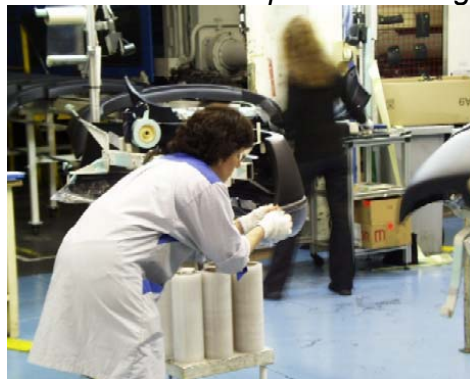
Atelier injection. Les gestes très précis requis pour l'insertion de bagues métalliques en sortie de presse ou la pose de papier collant au poste de marouflage, se font en force quand l'opérateur est crispé sur son outil à cause du froid ou du stress.
