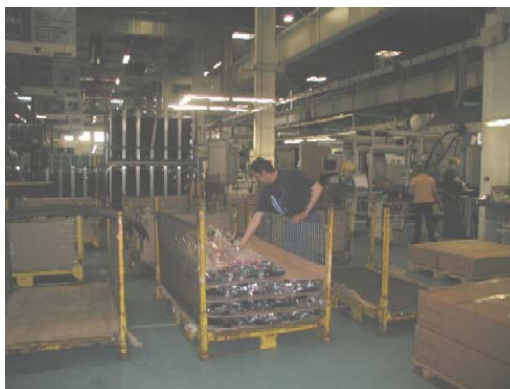
Les parois des chariots « ECA » doivent être assemblées manuellement avant de déposer les pièces.
