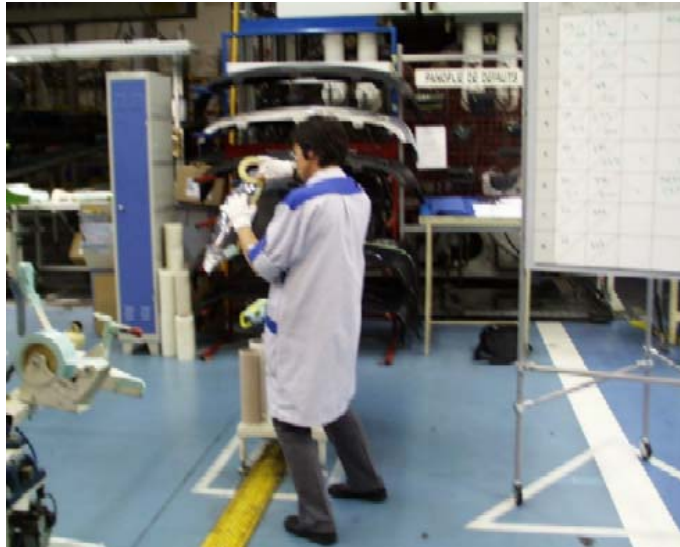
Poste de marouflage, pose de papier collant sur les pare-chocs automobiles pour protéger les zones non peintes.
